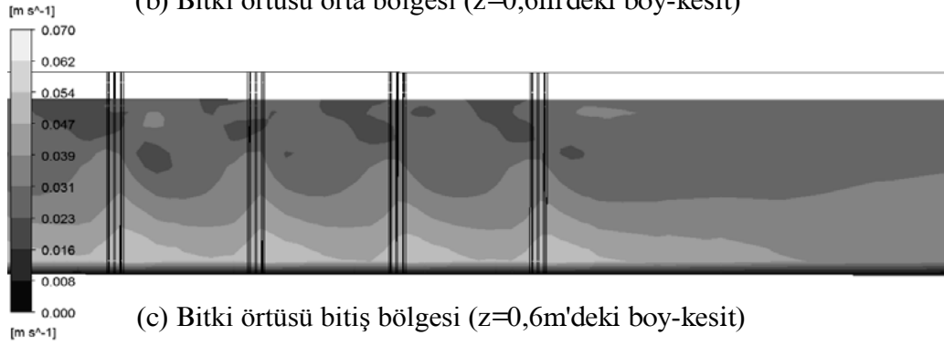
Şekil 5. Kanal boy-kesitinde boyuna doğrultuda hızın değişimi (Mesh tipi 2)
