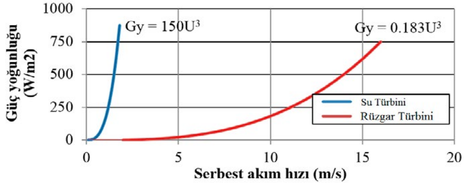
Şekil 1. Serbest akım su (hidrokinetik) ve rüzgâr türbinlerinin güç yoğunluğu açısından karşılaştırılması (Yüce ve Muratoğlu, 2015)
